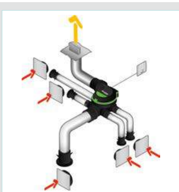
Solution EasyHOME® PureAIR Classic en combles avec réseau Algaïne
