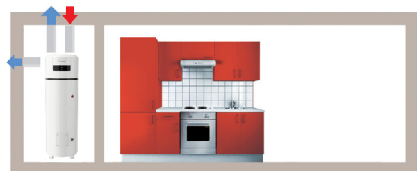
AIR EXTÉRIEUR AVEC GAINES POUR NE PAS REFROIDIR LA PIÈCE
