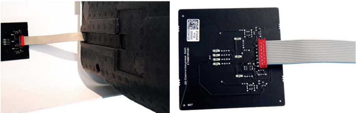
3. Retirer le support mural du boîtier en EPP, de sorte que l'appareil se présente maintenant débarrassé de tout composant du boîtier.
