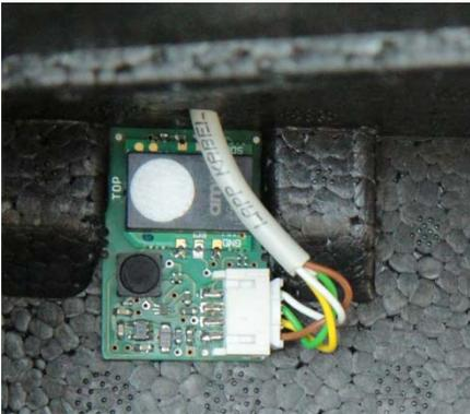
3. Placer la partie supérieure du boîtier en EPP sur la partie inférieure du boîtier en EPP. Poser le câble des capteurs à l'arrière et sur le côté dans la rainure de câble des parties de boîtier en EPP prévue à cet effet, de sorte que le câble aboutisse dans la zone de la platine de commande.
