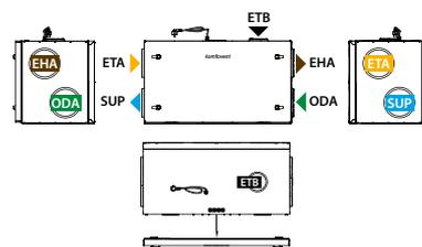
▶ ODA – prise d'air extérieur    ▶ SUP – soufflage    ▶ ETA – air extrait    ▶ EHA – rejet    ▶ ETB – Raccordement d'extraction supplémentaire (by-pass – extraction sans récupération de chaleur)
