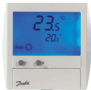
Ce thermostat d'ambiance digital électronique semi-encastré a été conçu pour vous apporter un maximum de confort et de sécurité. Il est spécialement adapté aux installations de PRE (Plancher Rayonnant Electrique), PLA (Plafond Rayonnant Electrique) ou STE (Sol Tempéré Electrique). Il régule la température ambiante en fonction de la température souhaitée et peut être raccordé à un programmateur ou à un gestionnaire d'énergie.
