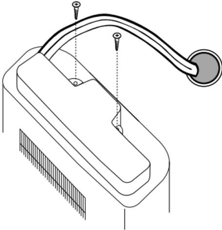
S'assurer que la liaison est bien maintenue avec la patte de fixation qui sera serrée sans la déformer pour ne pas abîmer les tubes ni pincer celui des condensats
