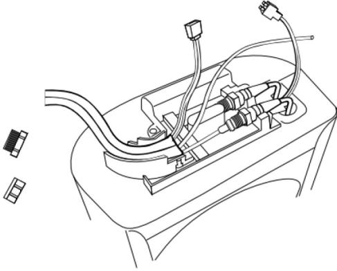
Lubrifier les joints des raccords rapides
