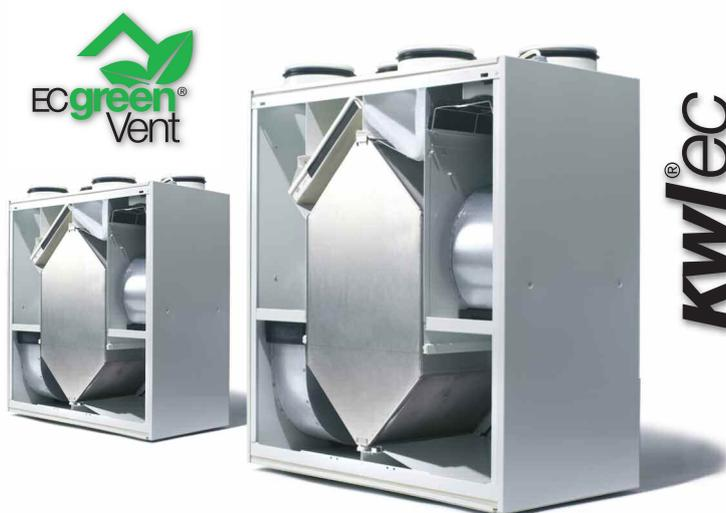
*Centrales double flux compactes murales, avec moteur basse consommation de technologie EC et récupération de chaleur. Débits de 200 à 500 m<sup>3</sup>/h.*
