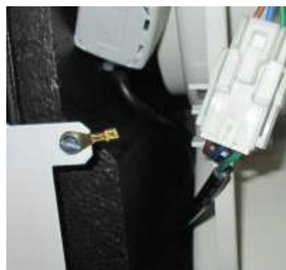
2.1 - Couper les deux extrémités du câble de terre du moteur gauche connecté au châssis.
