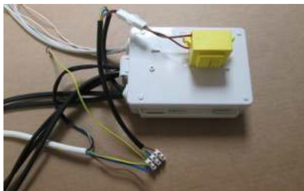
4.4 - Fermer le module (attention de ne pincer aucun câble).
