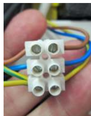
4.5 - Remonter avec précaution le module en laissant le bornier de connexion à l'extérieur. Dénuder les fils des 3 câbles du filtre coupés ultérieurement et les connecter au bornier de connexion en respectant la couleur des fils.
