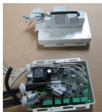
3.5 - ouvrir la boîte à l'aide des 4 clips sur le pourtour et passer à l'étape.3.8.
