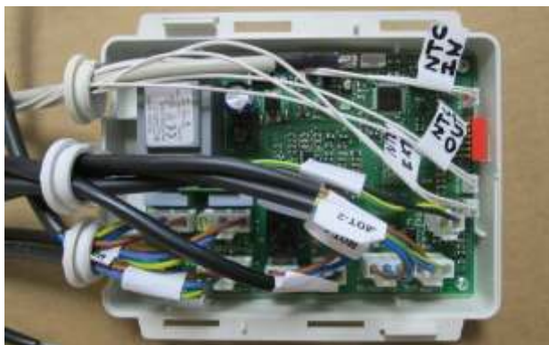
4.3 - Connecter tous les câbles en respectant les repères du circuit électronique.
