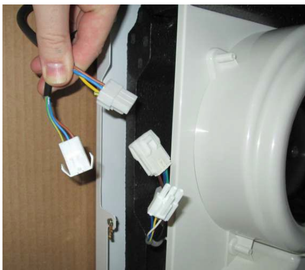
2.2 - Déconnecter les 2 câbles du moteur.
