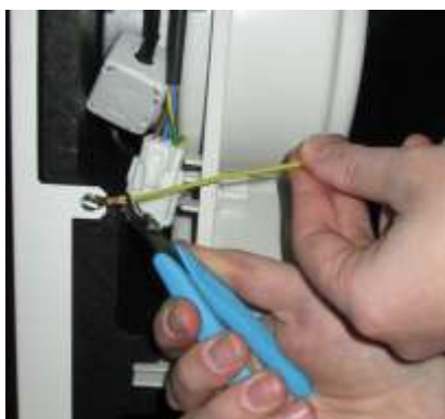
2.1 - Couper les deux extrémités du câble de terre du moteur gauche connecté au châssis.
