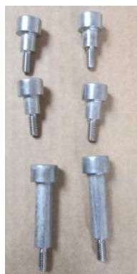
1.5 - Enlever les 6 vis à l'aide d'une clé Allen de 8. (Les 2 vis inférieures sont plus longues que les 4 autres).
