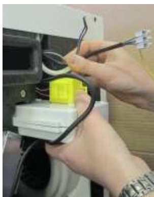
4.5 - Remonter avec précaution le module en laissant le bornier de connexion à l'extérieur. Dénuder les fils des 3 câbles du filtre coupés ultérieurement et les connecter au bornier de connexion en respectant la couleur des fils.
