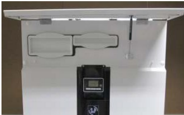
1.1 - Lever la trappe d'accès aux filtres.
