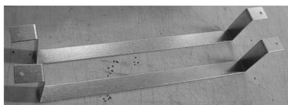
Les caissons de distribution se fixent au bâti au moyen de 2 équerres de fixation fournies avec le caisson. Elles entourent les 3 piquages latéraux de part et d'autre du caisson et sont vissées au bâti. (vis diamètre M5)
