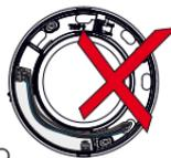
Aucun câble 100-240 V ne doit reposer sur les composants électroniques (figure O.)
